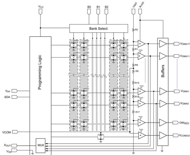
Fig. 1 AGT1818Block Diagram
